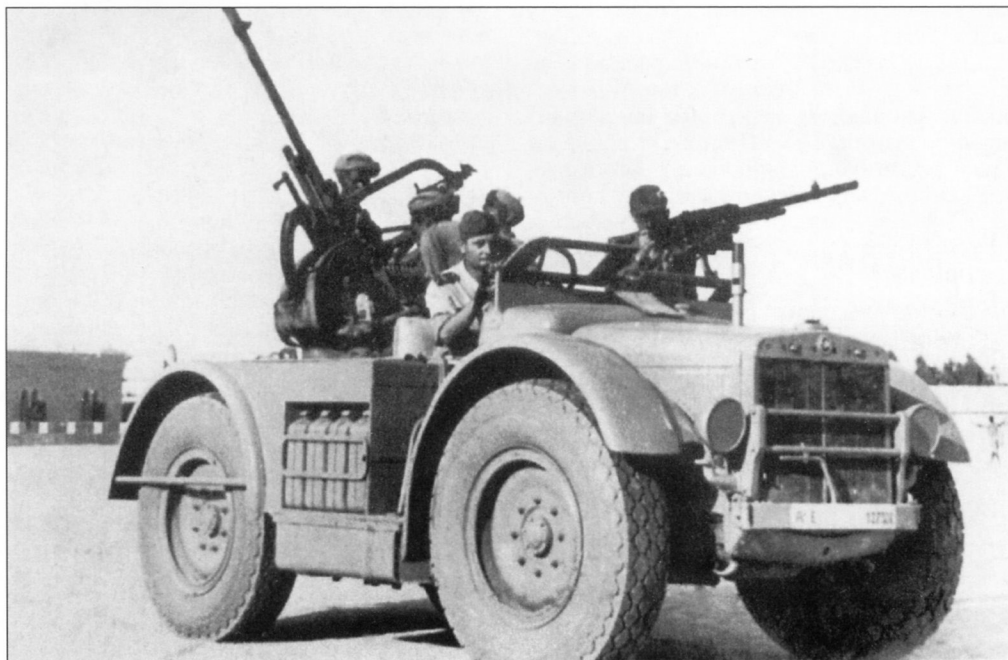
Усилиями армейских мастеров в Северной Африке многие тягачи AS 37 были превращены в боевые машины с мощным вооружением. На этой машине установлены крупнокалиберный пулемет и 20-мм автоматическая пушка
