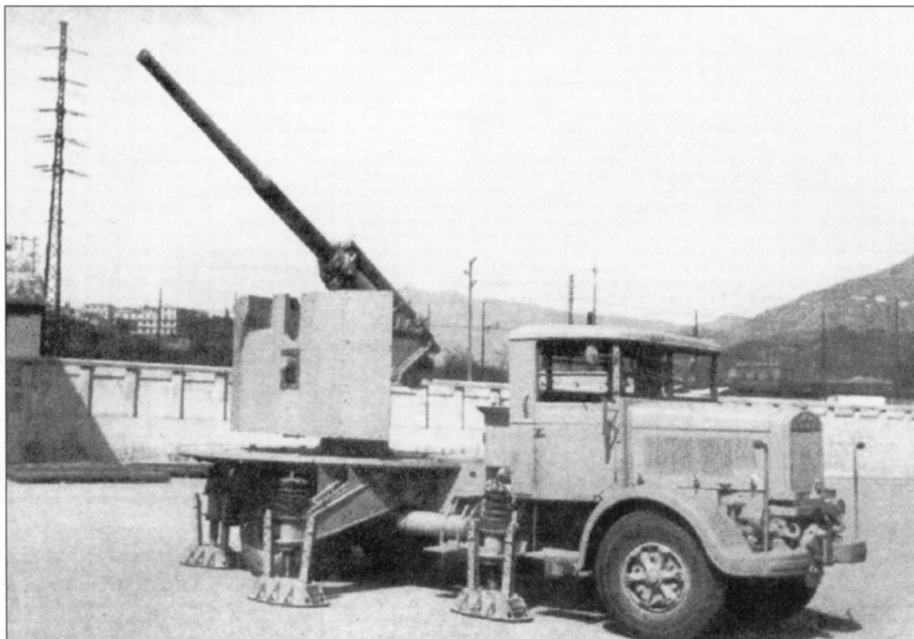
Autocannone da 90/53 на шасси Lancia 3Ro. Июнь 1941 года
