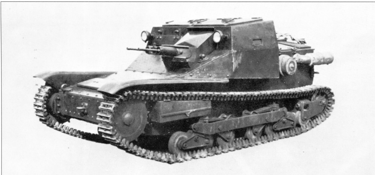
Танкетка CV3/33 2-й серии со спаренной установкой 8-мм пулеметов Fiat 35
