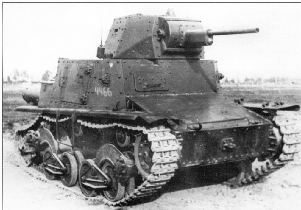
Легкий танк L6/40. Все танки этого типа оснащались радиостанциями
