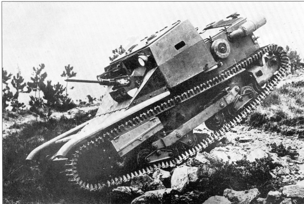
Танкетка CV3/33 1-й серии с одиночной установкой авиационного 6,5-мм пулемета Fiat 14
