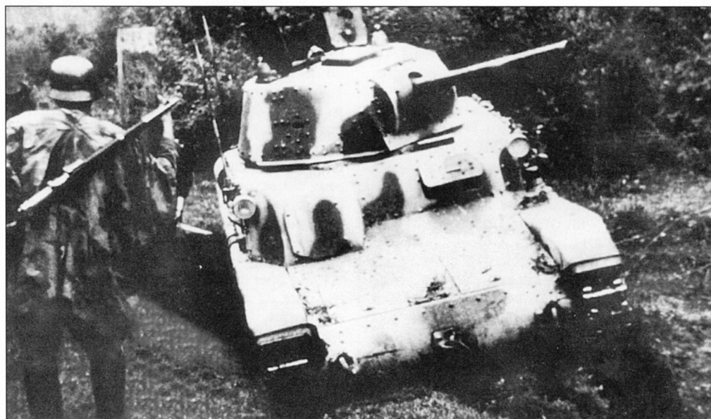
Танк Pz.Bef.Wg.M42(i) из состава 7-й добровольческой горнотранспортной дивизии СС «Принц Евгений». Италия, 1944 год. Хорошо видны две антенны на корпусе машины и заглушенная амбразура спаренной установки 8-мм пулеметов Breda.
