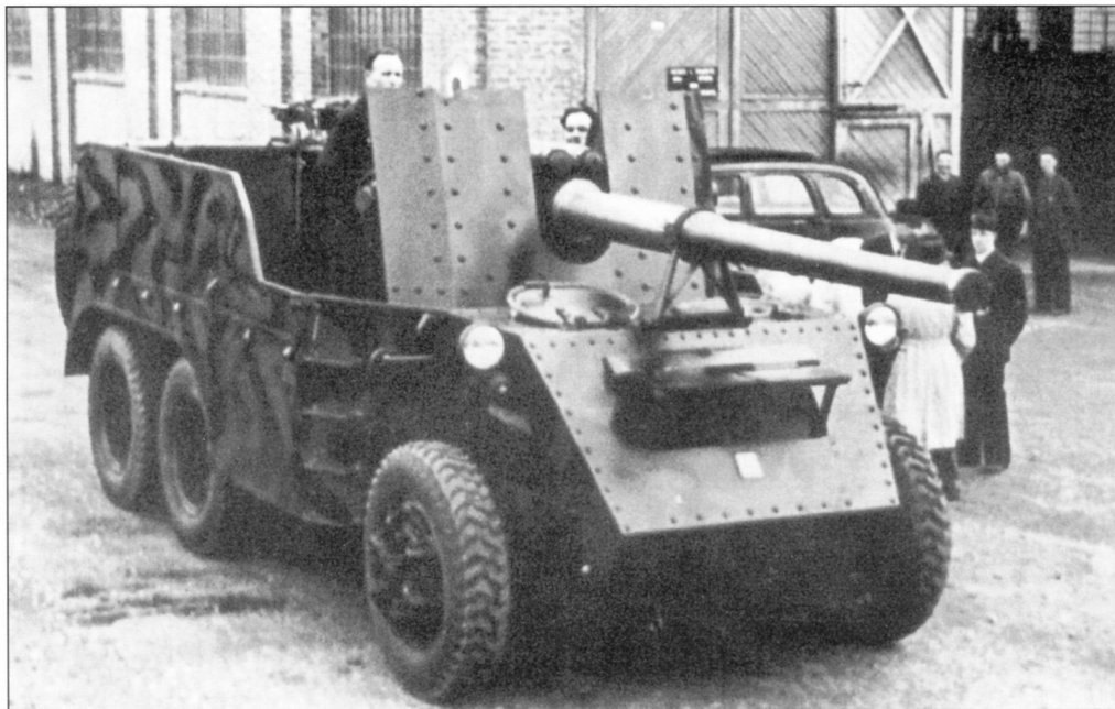
Прототип истребителя танков на шасси Breda Tipo 102, вооруженный 90-мм пушкой
