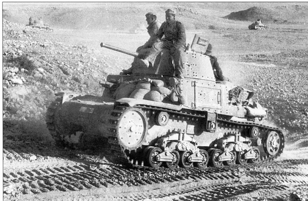
Стремясь хоть как-то усилить слабую бронезащиту своих машин, экипажи обкладывали танки М13/40 мешками с песком
