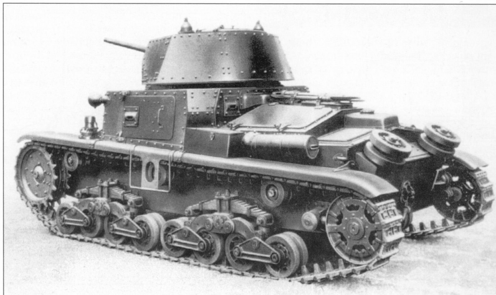
Кормовая часть корпуса М13/40 почти не изменилась по сравнению с М11/39. Однако из-за установки новой башни танк стал на 12 см выше предшественника
