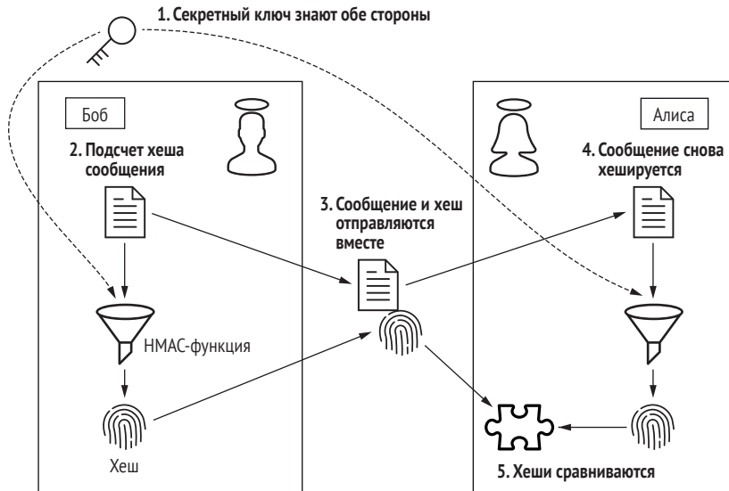
Рис. 3.3 Алиса удостоверется, что данные присланы Бобом, с помощью общего ключа и HMAC-функции
