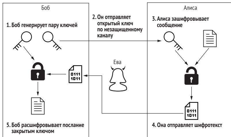
Рис. 5.1 Данные, отправленные Алисой Бобу с помощью асимметричного шифрования, остаются неразглашенными Еве
