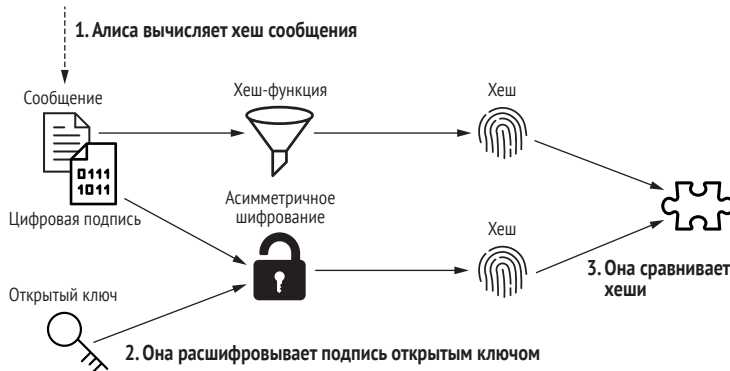
Рис. 5.3 Алиса получает сообщение от Боба, расшифровывает ЭЦП открытым ключом отправителя и сравнивает хеши. В этом и заключается проверка подписи
