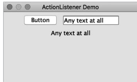
Рис. 10.30. Использование событий ActionEvent от разных источников
