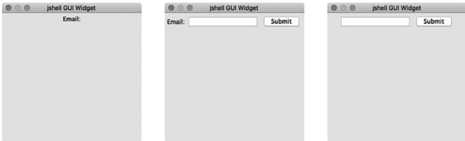
Рис. 10.22. Добавление и удаление компонентов в JPanel
