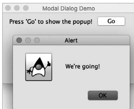
Рис. 10.31. Простое модальное окно на базе JOptionPane
