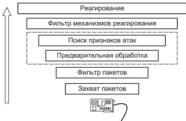
Рис. 21.6. Подключение и схема работы сетевой IDS
