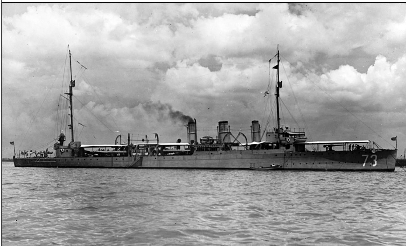
«Стоктон» вскоре после окончания Первой мировой. Видно, что часть вооружения с корабля снято: нет 1-фунтовых автоматов и кормовых бомбосбрасывателей
