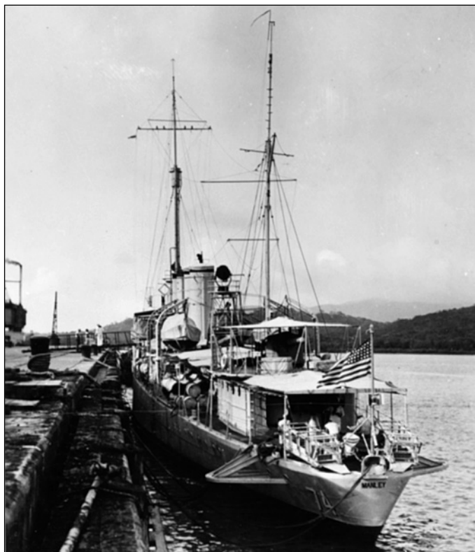
Эсmineц «Мэнли» в Бальбоа, 1936 г. Хорошо видно кормовое 102-мм орудие, поднятое в ходе модернизации начала 20-х с палубы юта на кормовую надстройку
