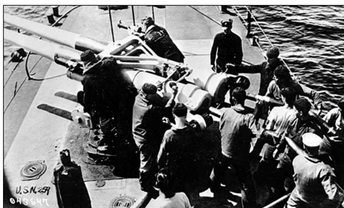
Носовая сдвоенная 102-мм установка эсминца «Стоктон». Фото наглядно демонстрирует, насколько она неудобна в обслуживании – расчету попросту не хватает места на палубе
