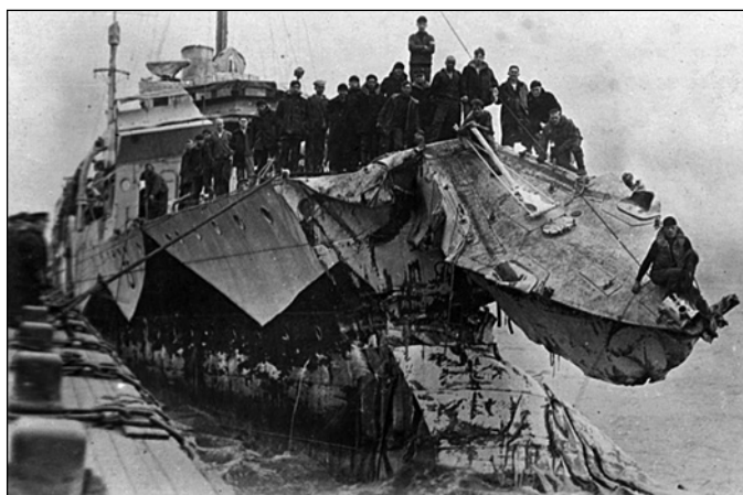
Свернутый нос эсминца «Стоктон» после столкновения с пароходом «Слив Блум»
