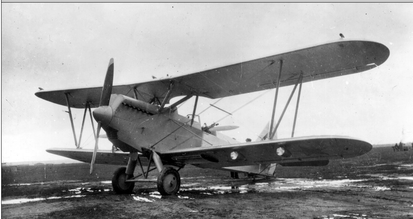
Опытный штурмовик ТШ-2 недалеко от здания ЦКБ. Под нижним крылом размещены сбрасываемые при боевом повреждении топливные баки. Весна 1931 г.
