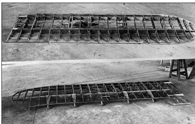
Левые плоскости крыльев самолета (нижняя и верхняя) без тканевой обшивки
