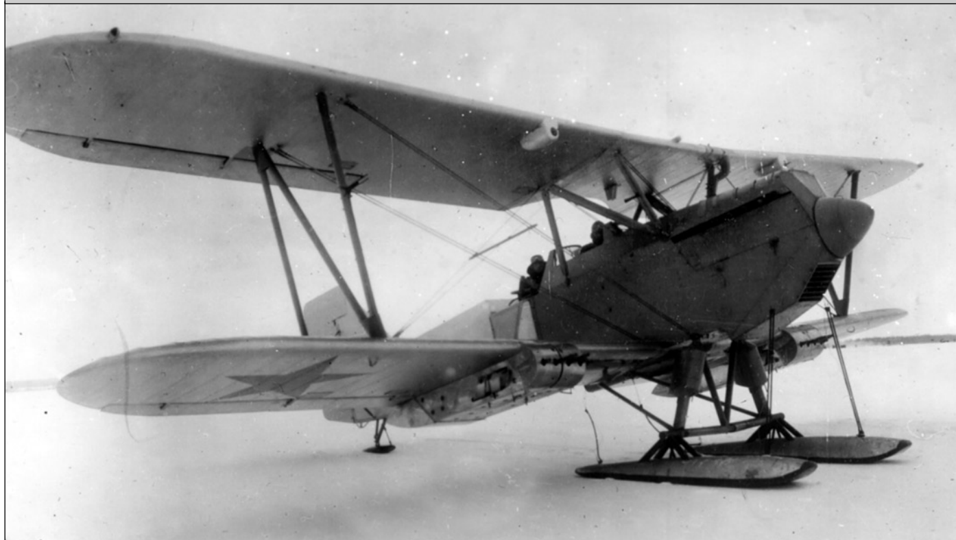
Опытный штурмовик ТШ-1 во время испытаний на лыжном шасси в зиму 1930-31 годов
