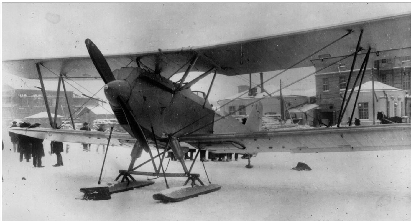
Опытный штурмовик ТШ-1 во время испытаний на лыжном шасси в зиму 1930-31 годов
