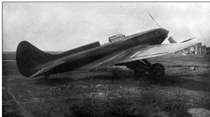
Первый опытный истребитель ЦКБ-15 (И-17) отличался большим наклоном основного шасси, что значительно осложнило работу шасси. На представленном фото самолет оборудован неубираемым шасси. 1935 г.
