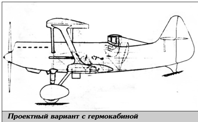
Подправленный оригинальный боковой компоновочный вид самолета ЛР
